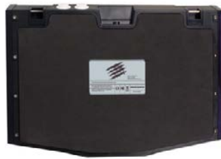
膝置き時の安定性と快適性が高い フォームパッド仕上げの底面
